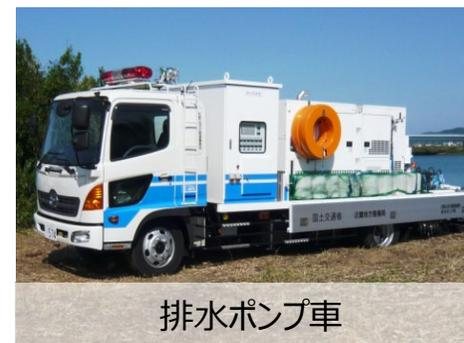
大雨などの際に、浸水した箇所に緊急出動して、ポンプによる排水を行ない、早期の浸水解消のために活躍します。
