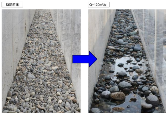
写真4 初期河床と計画流量 120 \text{ m}^3/\text{s} 通水後の比較
