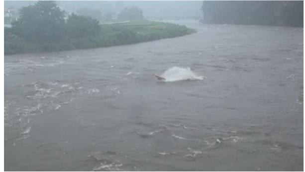
写真-9 曳航式ADCPの跳ね上がり状況写真
