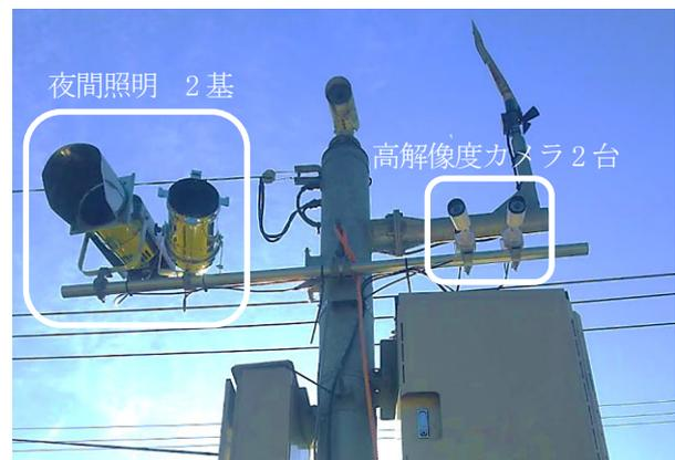
写真-5 柿坂観測所 画像解析用カメラ設置状況
