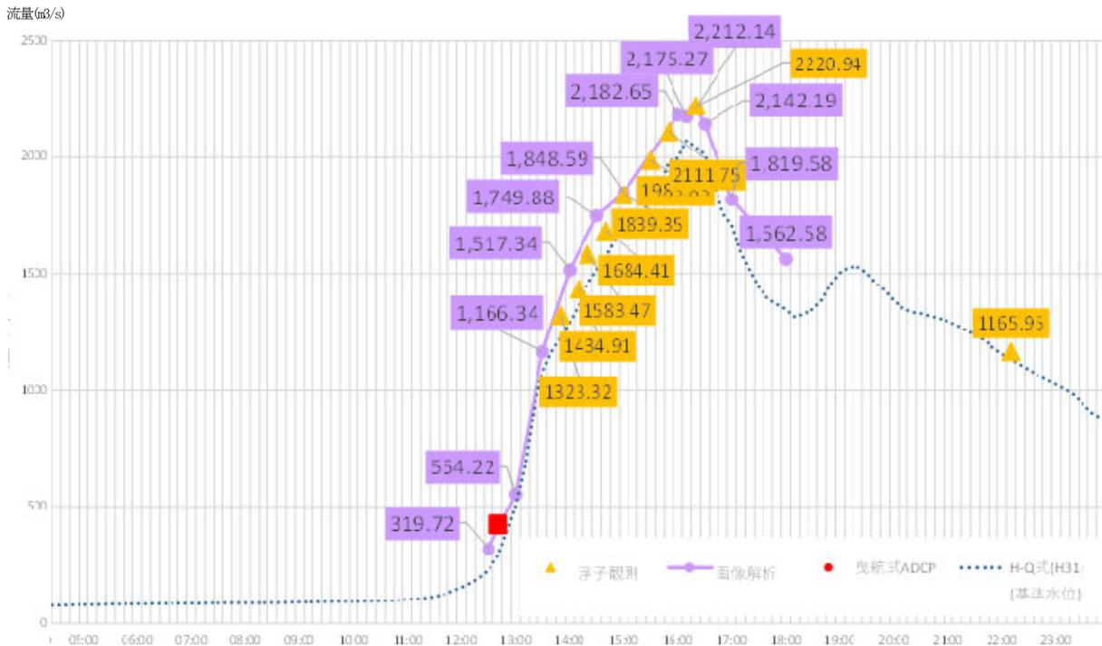
図-12 2020年7月6日 画像解析、ADCP、浮子観測による流量算出結果
