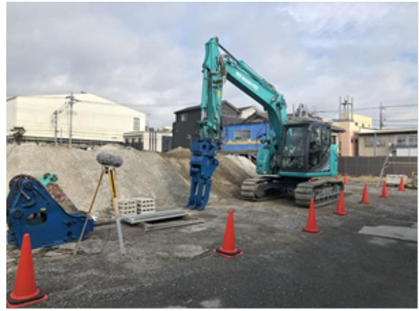
図-14 作業音声取得の検証状況
