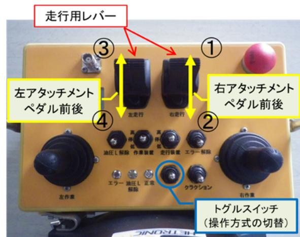
図-10 リモコンによるアタッチメント操作方式2
