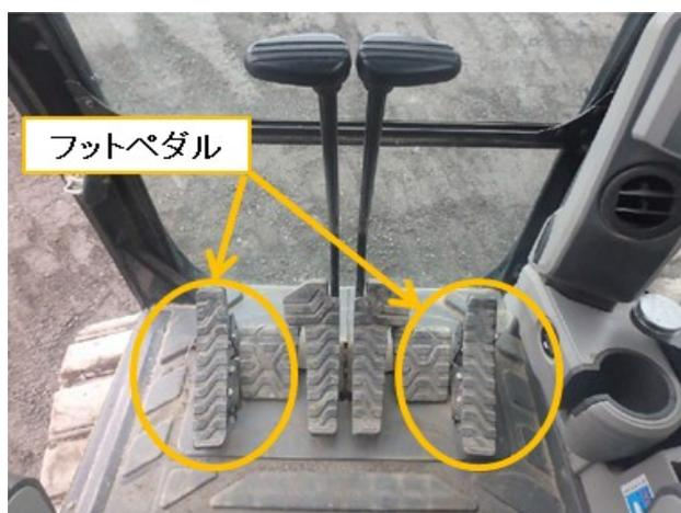
図-4 アタッチメント操作用フットペダル
