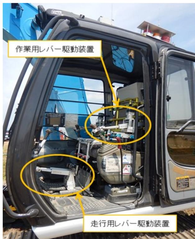
図-3 操縦席へのロボQS設置状況
