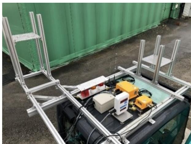
図-13 4視点カメラ設置用架台
