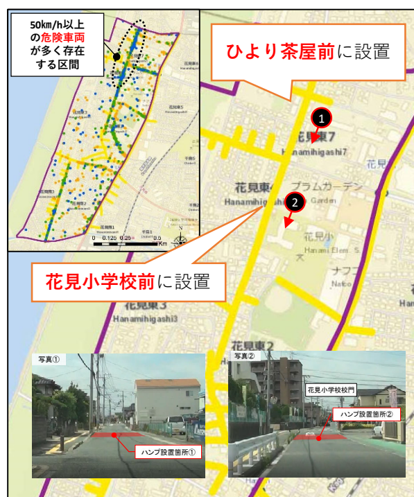
図-6 可搬型ハンプ設置箇所
