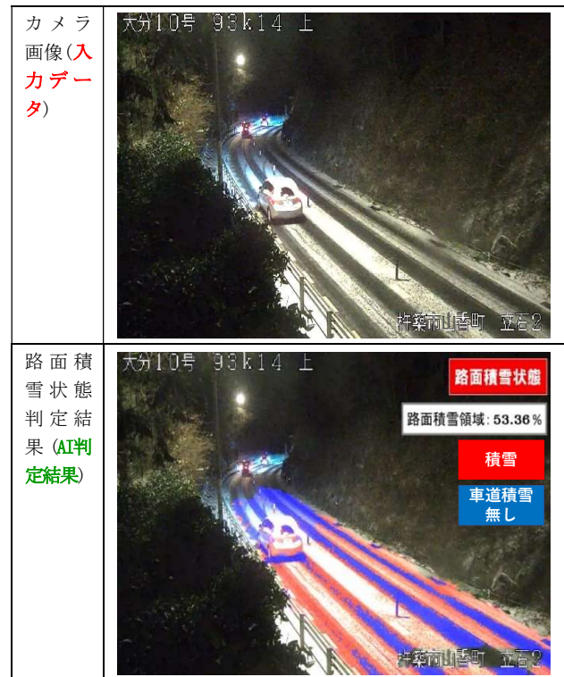
図-10 路面積雪状態判定 (国道10号 大分 立石2)
