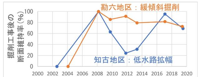
(図-4) 掘削工事後の断面維持率
