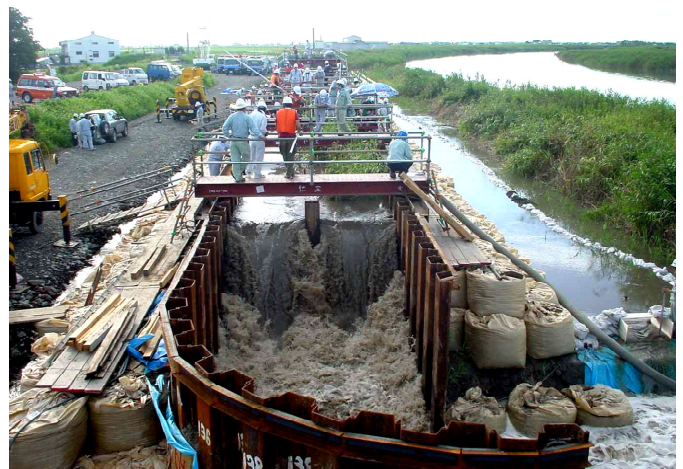
図-7 流水中のヨシ挙動の現地通水実験の様子
