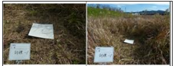
写真-5 植栽繁茂箇所の対空標識設置の様子
