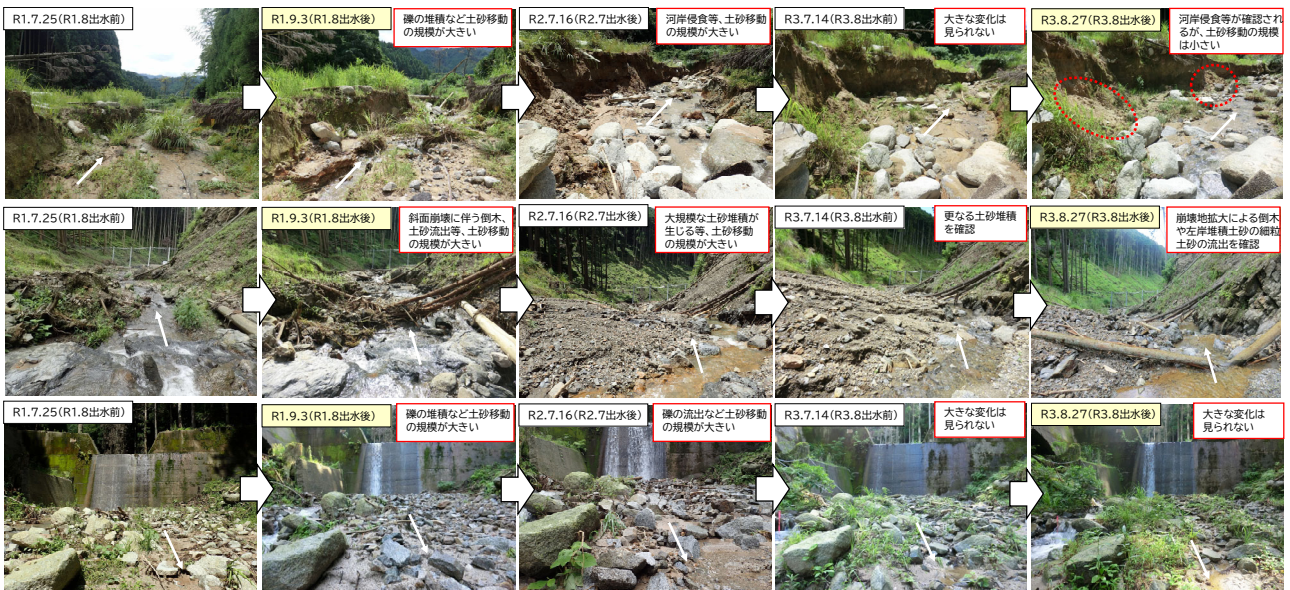
図-7 主な溪流におけるR3.8出水後までの土砂移動状況（上：赤谷16、中：赤谷35、下：乙石21流域内）
