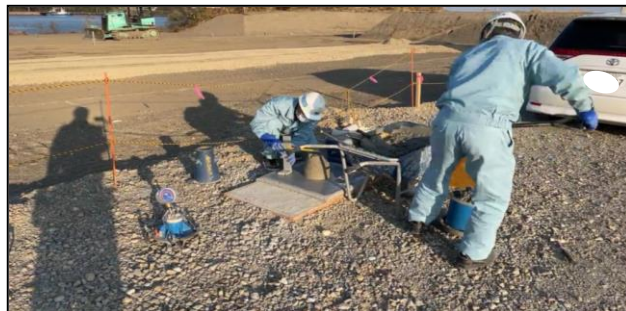
写真-8 遠隔臨場画面 スランプ試験状況
