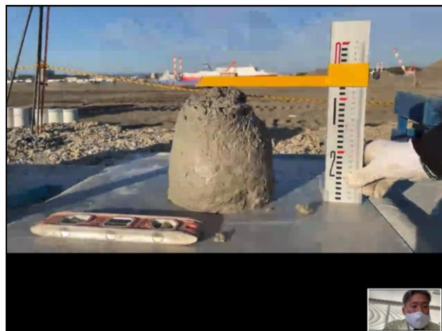
写真-9 遠隔臨場画面 スランプ試験数値確認状況
