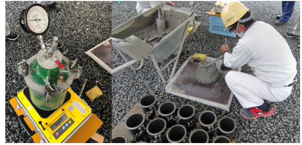
写真3 コンクリート受け入れ検査の様子
