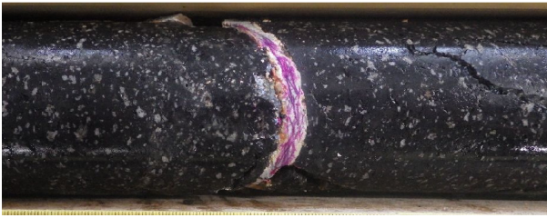
写真-5 亀裂性岩盤のコア
