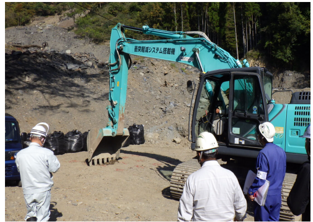
図-5 3Dガイダンス調整状況
