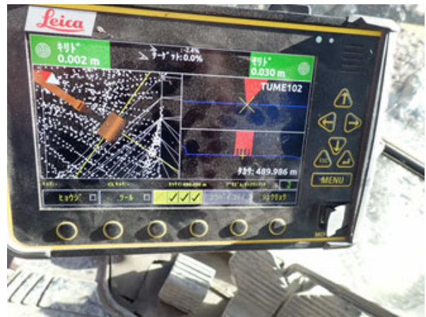
図-6 バケット先端位置の確認
