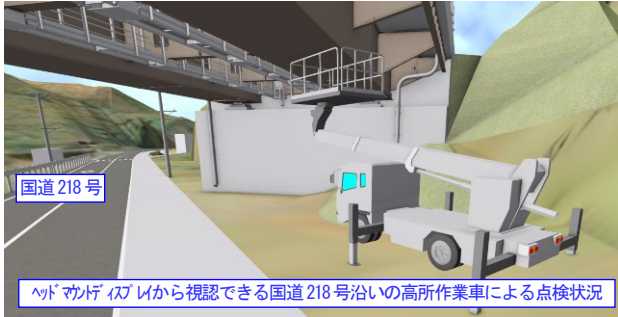
図-9 VR活用③：高所作業車での点検確認
