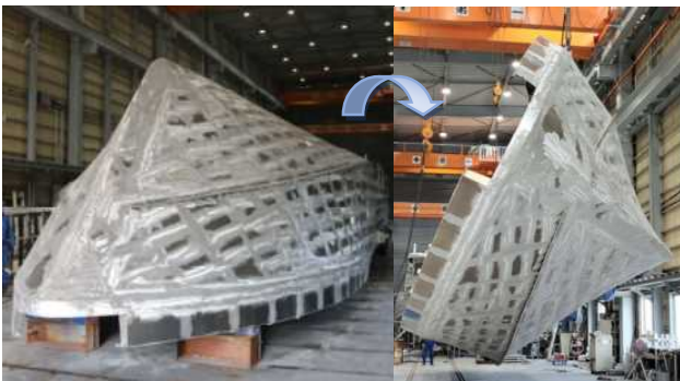
写真5 船体反転（倒立建造）
