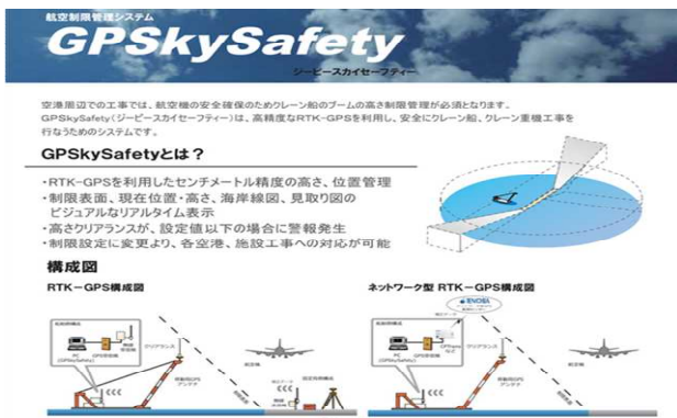
図-8 クレーン船のブーム高さ制限管理システム (出所:株式会社アカサカテック)
