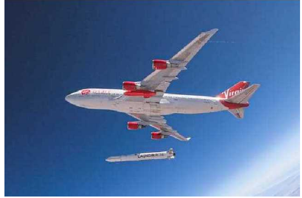
写真-2 航空機で人工衛星を打ち上げ (出所:Virgin Orbit/Greg Robinson)
