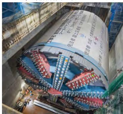
図-2 本工事で使用するシールドマシン
