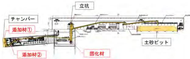
図-6 本掘進時のシールド掘削土砂の流れ
