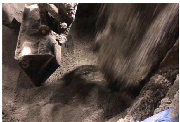
図-5 改質後の土砂の状況(攪拌機通過後)
