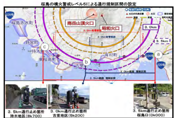
図4 遠隔式遮断装置設置位置
