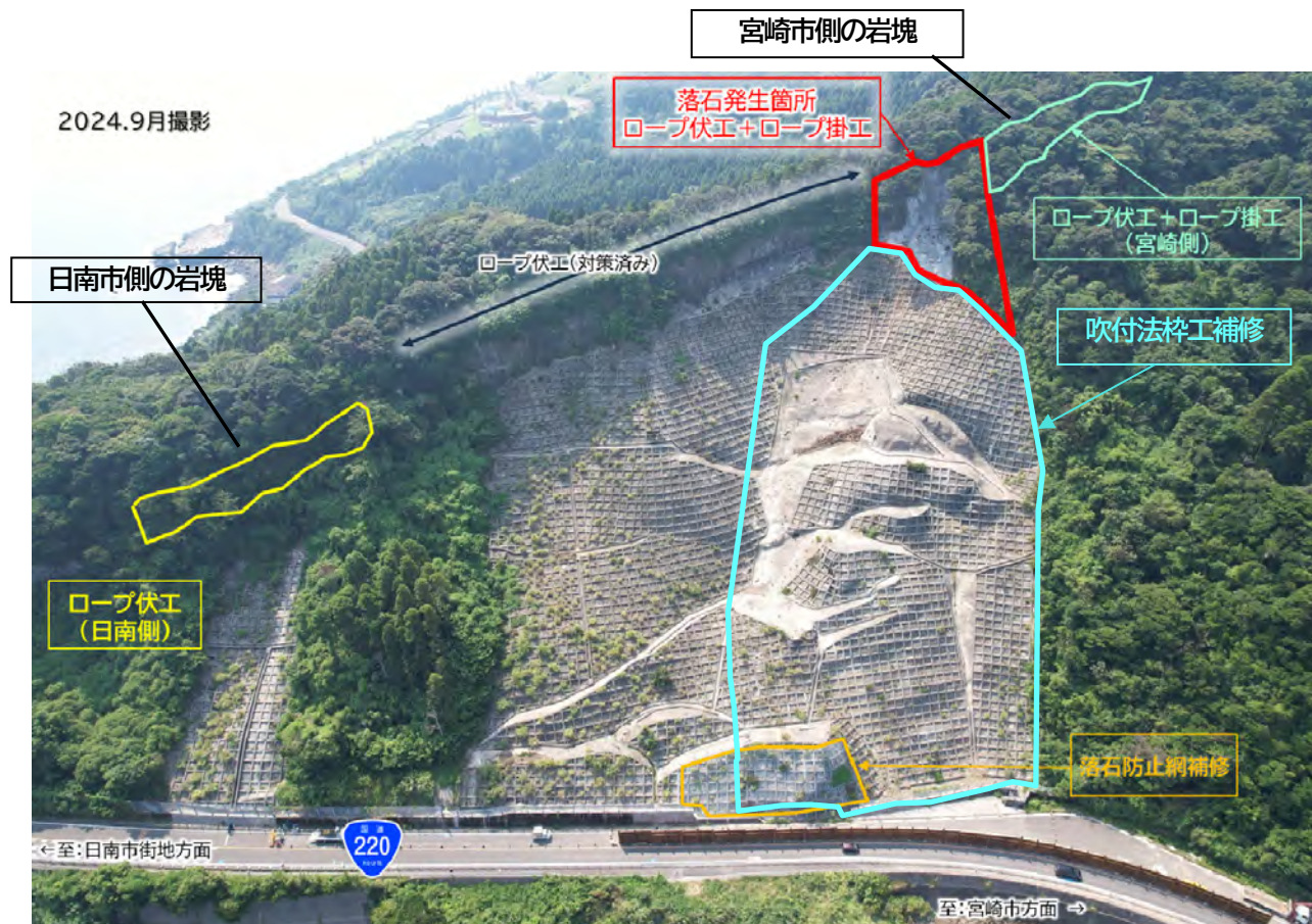
写真12 本復旧対策工法計画
