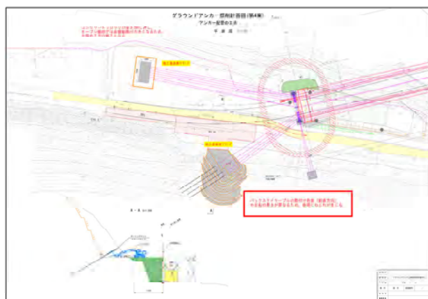
図-10 グラウンドアンカー掘削計画図
