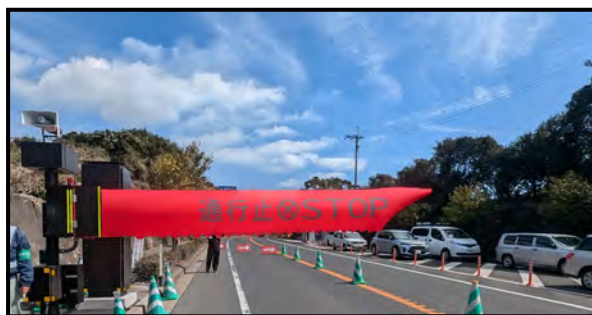
写真4 遮断装置作動時の様子
