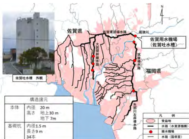
図1 佐賀吐水槽の位置図、外観、構造諸元
