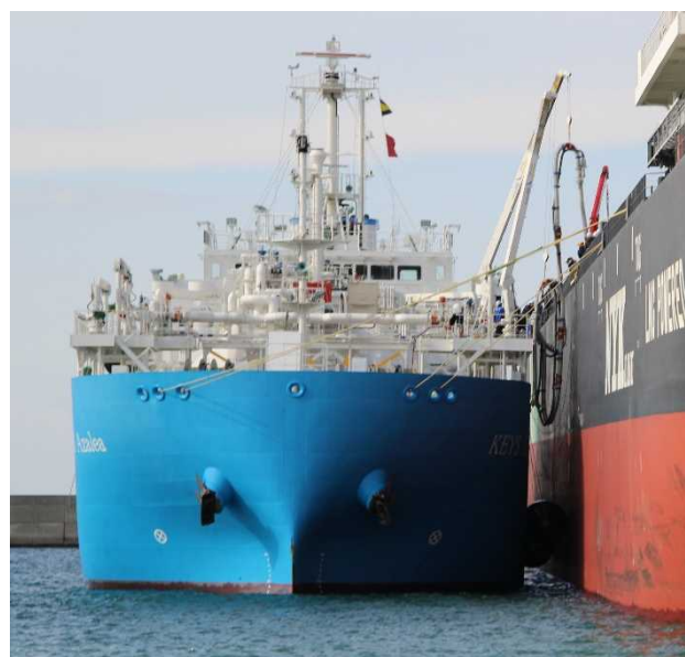
(写真-1) LNG バンカリング (Ship to Ship) の様子 左 LNG バンカリング船 (KEYS Azalea) 右 LNG 燃料船 (松陽)
