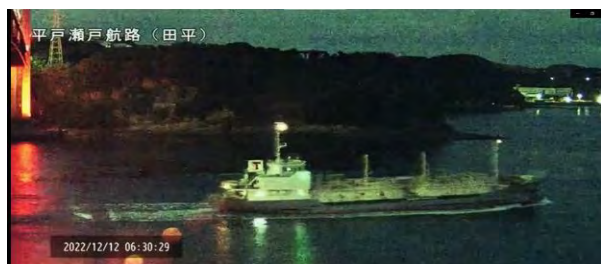
写真-11 AIによる異常検知（画像が暗く未検知）
