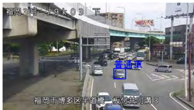
図-5 変則的な交差点の右折車両を「避走」と検知した例
