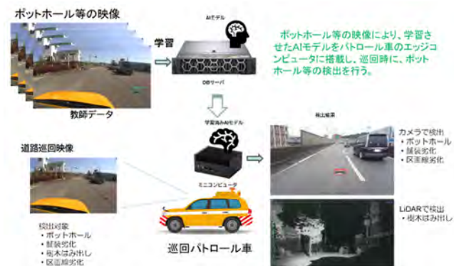
図-8 エッジAIカメラシステムの異状検知の流れ
