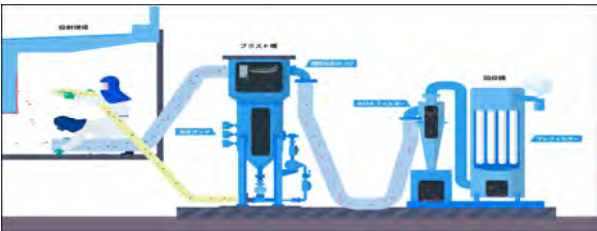
図-2 循環式ハイブリッドブラストシステム工法の概略図
