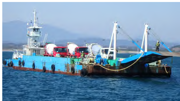
図-5 フェリーバージによるアジテータ車の海上運搬
