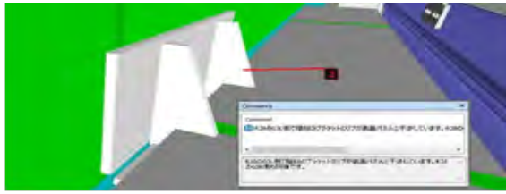
(a) BIM/CIMモデルによる干渉確認
