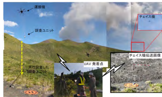
図-5 IoT調査ユニット設置状況
