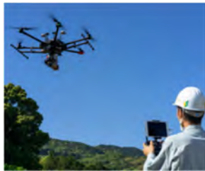
図-9 高性能レーザースキャナ UAV
