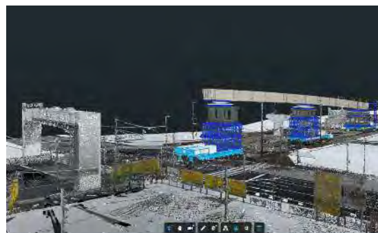
図-12 架設シミュレーション
