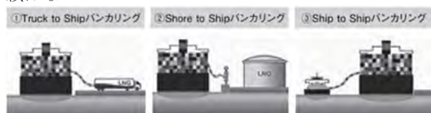
(図-3) LNG バンカリングの手法
