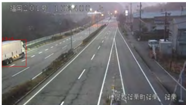
図-4 路側帯に停車している車両を「停止」と検知した例
