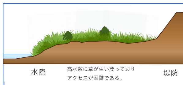
図-4 河川敷の段差と水際アクセス不良
