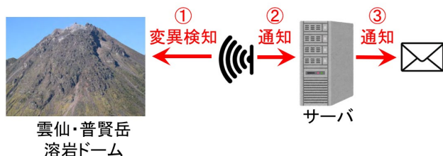
図-3 溶岩ドーム観測システム
