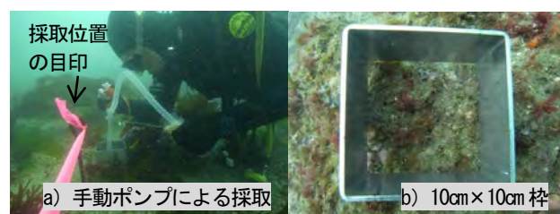
写真-4 堆積泥の採取状況
