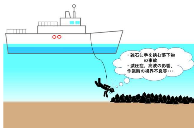
図-6 人力による雑石均し
