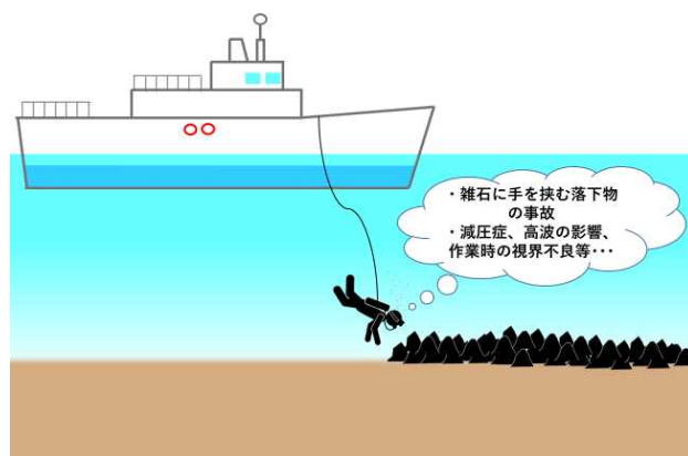
図-6 人力による雑石均し
