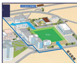
久留米市: 久留米大学グラウンドでの雨水貯留(筑後川水系)
