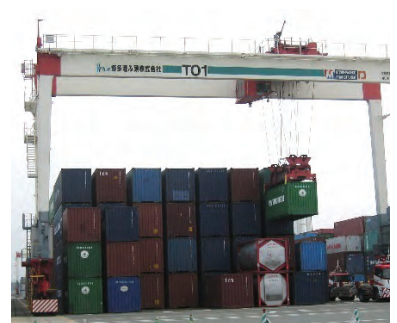
博多港の荷役機械(RTG)電動化
