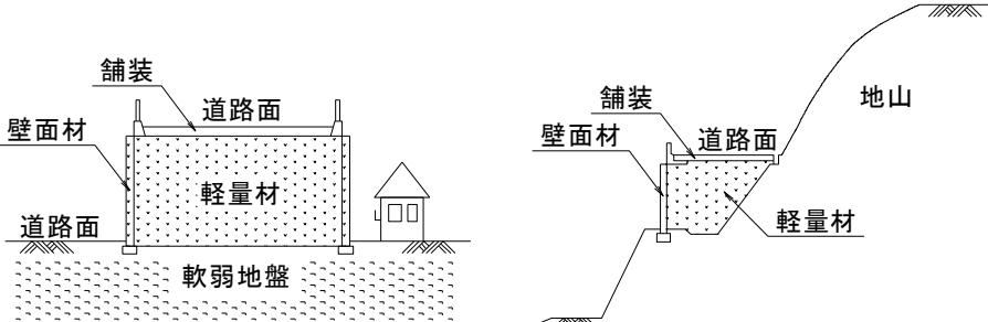
(c) 軟弱地盤における沈下、側方変形対策として用いる場合
