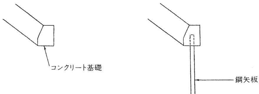
図3-13 基礎工およびのり留工の例
