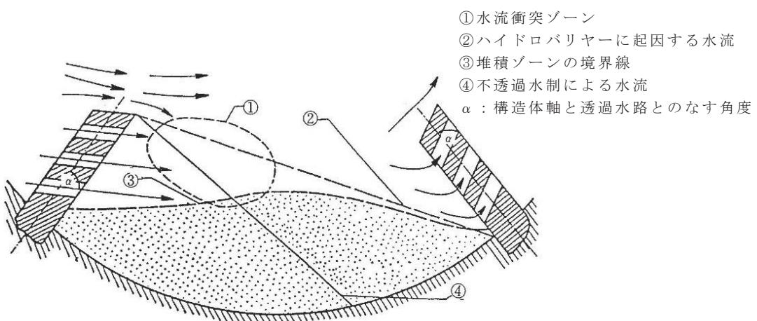
土砂堆積型ハイドロバリヤー水制の概念図
