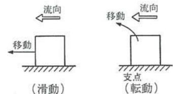
②転倒：流体力の作用によって一点を支点として部材
