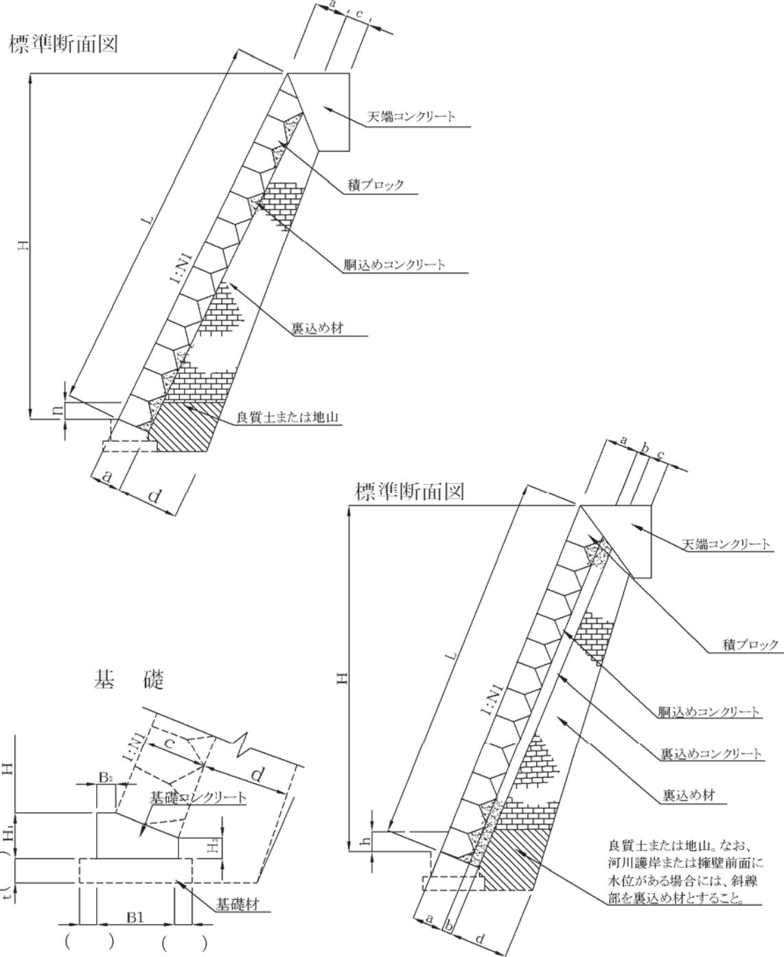
※ 河川の施設災害としては、河床洗掘及び護岸天端を水が走ることに伴う洗掘で被災することが多く、従来から河川天端コンクリートは2-5に示す肩止めコンクリート④に示す形状を用いている。但し、川裏水路等で流れの影響を考慮する必要がないような場所に用いるブロック積みの天端コンクリートは、標準設計に示されている天端コンクリートを用いてよい。
