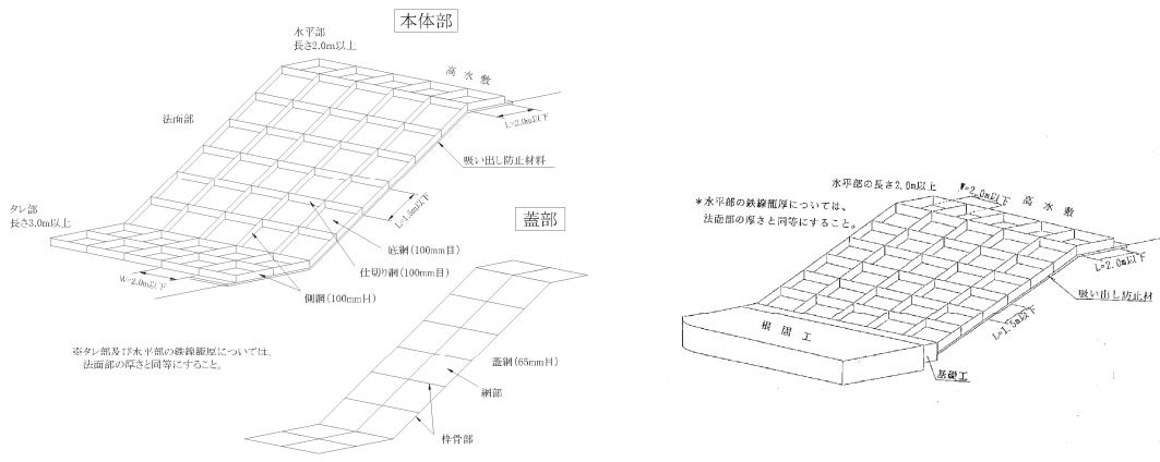
図 3-5 鉄線籠型護岸
