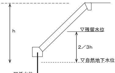
図 3-18-2 残留水位の水位高（常時、自然地下水位あり）
