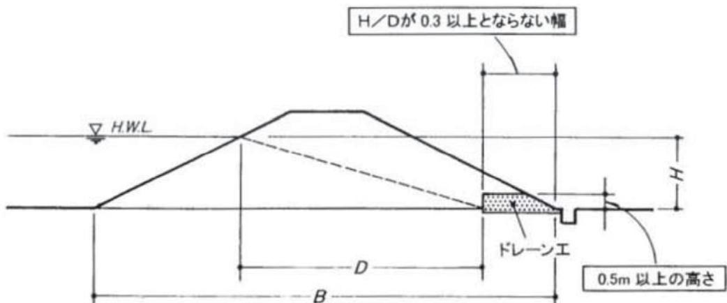
図1-7 ドレーン工の断面と平均動水勾配
