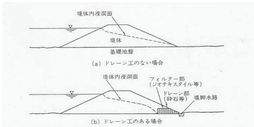
図1-6 ドレーン工の構造とその効果
