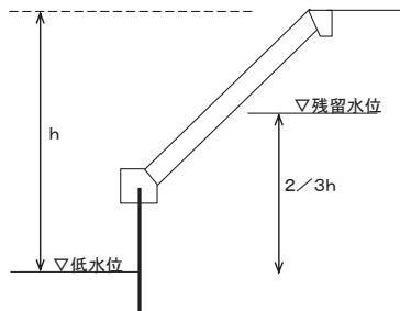
図 3-18-1 残留水位の水位高（常時）
