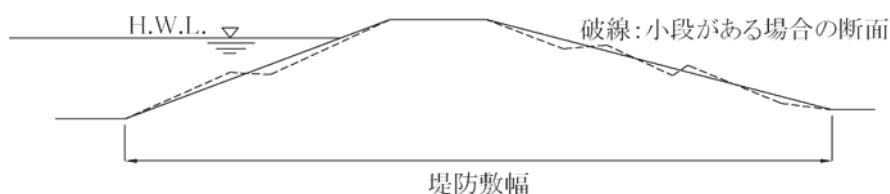
図1-3 小段のあるのり面を緩勾配の一枚のりにする例
