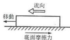
②めくれ：流体力の作用によって部材がめくれる現象である。小口のないのり覆工端部等に生ずる。例えば、すり付け護岸の連節ブロック端部の破壊現象にみられる。
