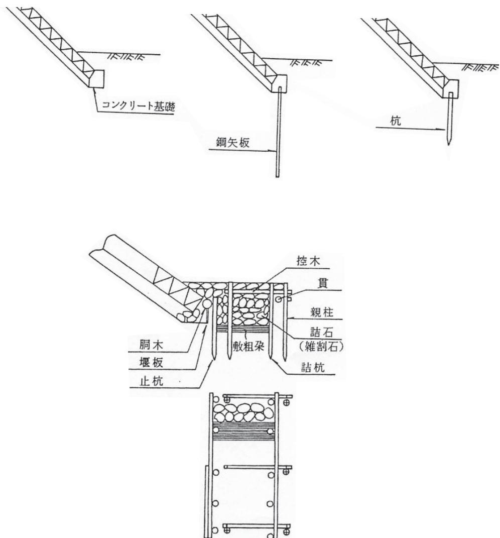
図3-14 基 础 工 例
