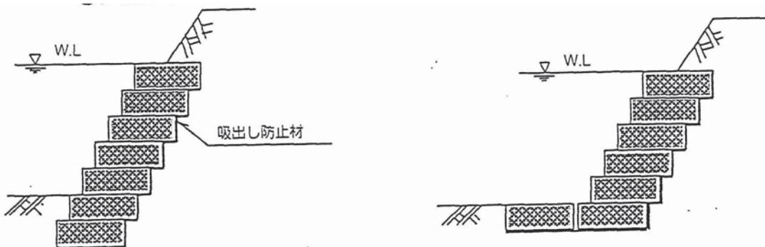
図 3-6 鉄線籠型多段積工の例
