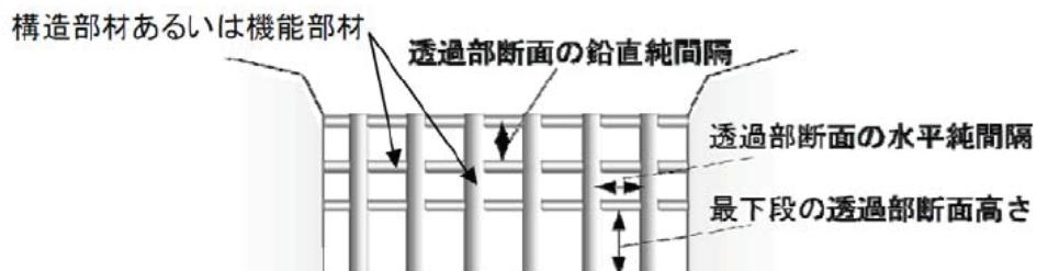
図 2-39 透過部断面の純間隔
