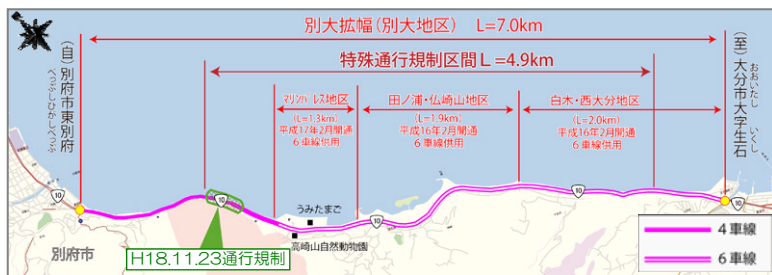
▲ 道路整備状況に伴う通行規制延長の変化
