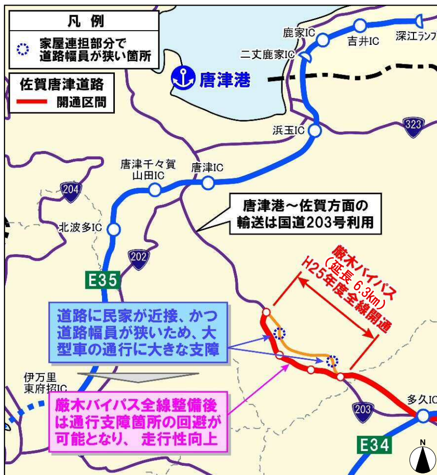
▲ 旧国道203号の大型車と沿道の関係
