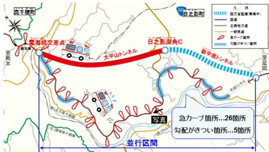
▲ 線形不良箇所の状況
