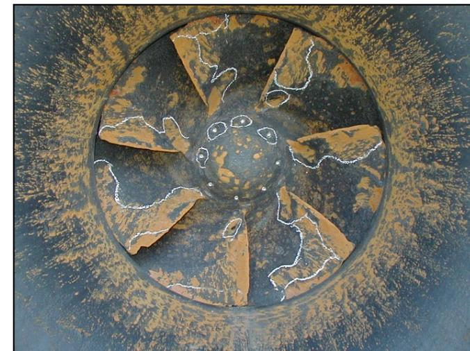
腐食した排水ポンプ場の羽根車
