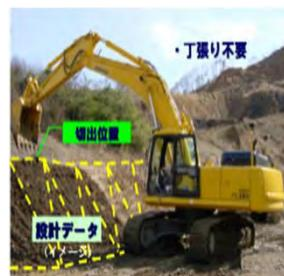
3次元設計データによりICT建設機械にて施工(MC/MG)
