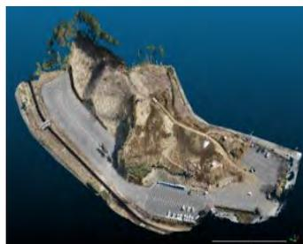
ドローンやTLSによる高効率な3次元測量
