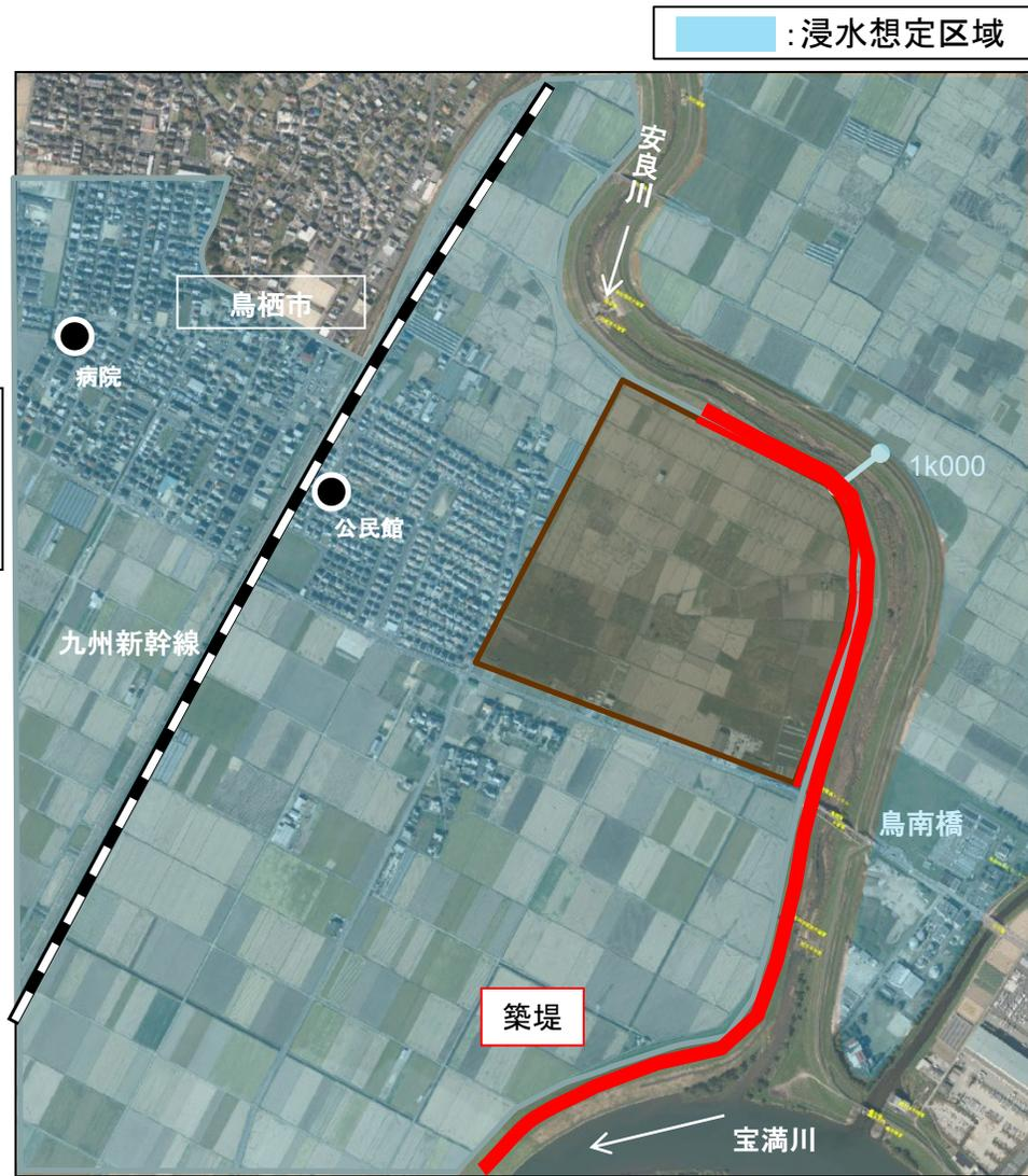
■ 嘉瀬川尼寺地区において、平成22年7月洪水での浸水被害や気候変動の影響による災害の激甚化・頻発化に対応するため、築堤、掘削・樹木伐採を行うことで、治水安全度の向上を図る。
