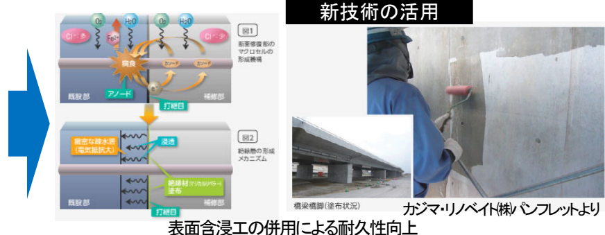
新技術活用による耐久性向上とLCC縮減
