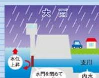
雨が降り、川の水位が上昇。本川から内水側への水の逆流を防ぐため水門を閉める。
