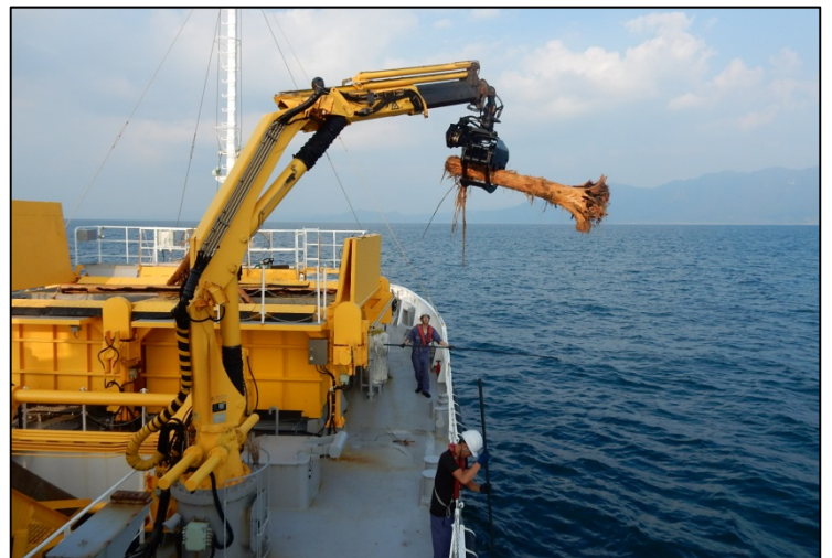
海煌の多関節クレーンを使用した流木回収状況
