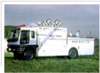
排水ポンプ車
