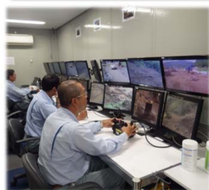
▲遠隔操作で14台の無人化機械が稼働
