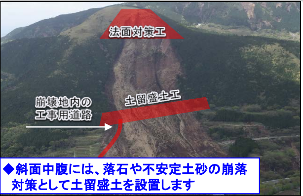
◆斜面上部の不安定土砂を取り除き法面对策工を実施します
