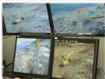
▲遠隔操作で14台の無人化機械が稼働
