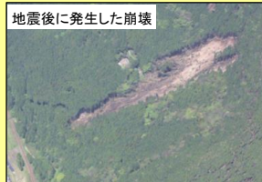
亀裂による地盤の緩みの発生状況(阿蘇大橋付近の西側斜面)
