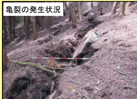
亀裂による地盤の緩みの発生状況(阿蘇大橋付近の西側斜面)
