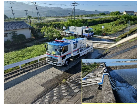
配水ポンプ車による配水支援 (熊本県玉名市)
