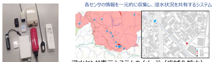
実証実験中の浸水センサ及び表示システム
