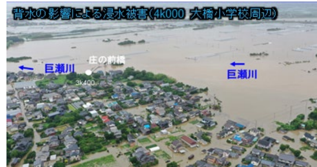
▲R5.7洪水における巨瀬川の浸水被害状況 筑後川の背水の影響で越水している。
