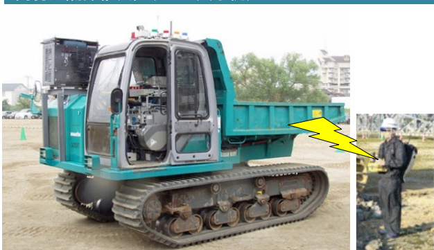
簡易遠隔操縦装置(ロボQ)(事例)
