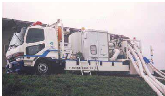
写真 4.3.1 排水ポンプ車
