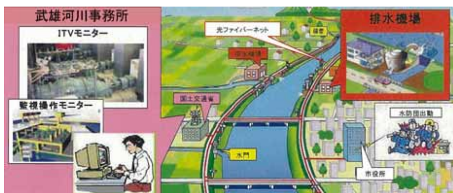
図 4.3.3 遠隔監視操作のイメージ
