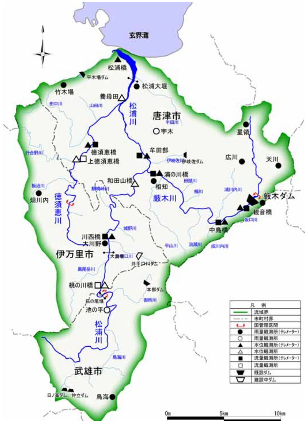
図 4.3.5 松浦川流域の雨量・水位観測所位置図
