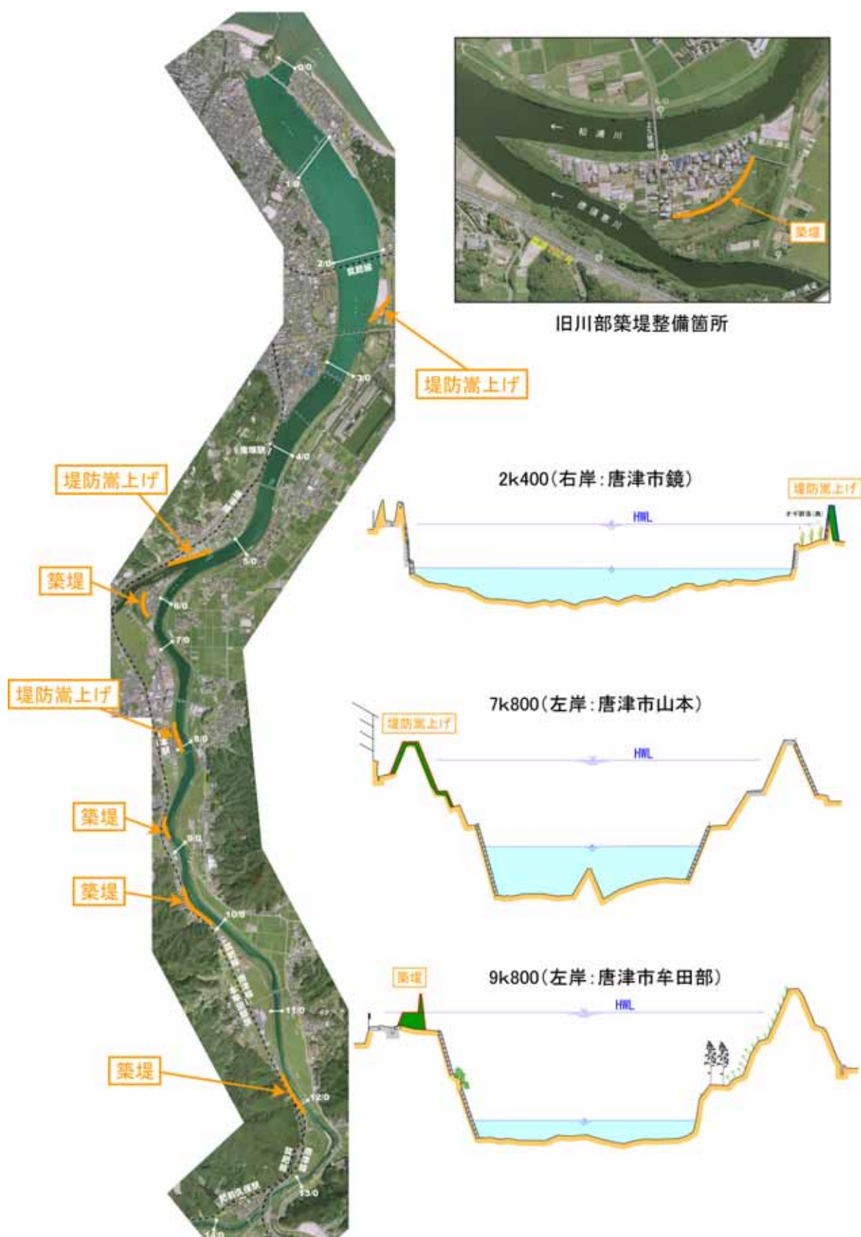
図 4.2.5 整備箇所位置図（松浦川 河口～14k000）
