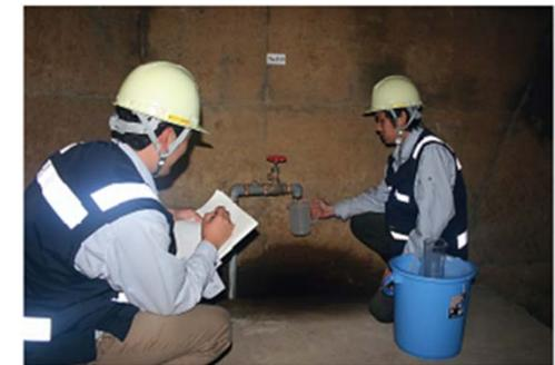
漏水計による漏水量の計測
