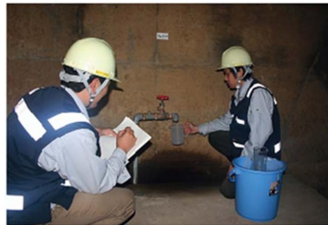
漏水計による漏水量の計測
