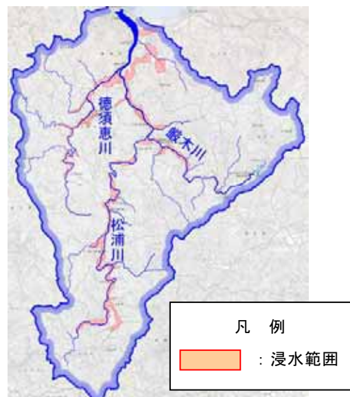
図 1.2.1 平成 2 年 7 月洪水浸水状況図 梅雨前線豪雨により、越水など各所で発生し、深刻な被害を受けました。松浦川本川、支川徳須恵川、支川巖木川の 3 河川で、越水被害延長 25,700m、越水被害額 60 億円にのぼる大出水となりました。
