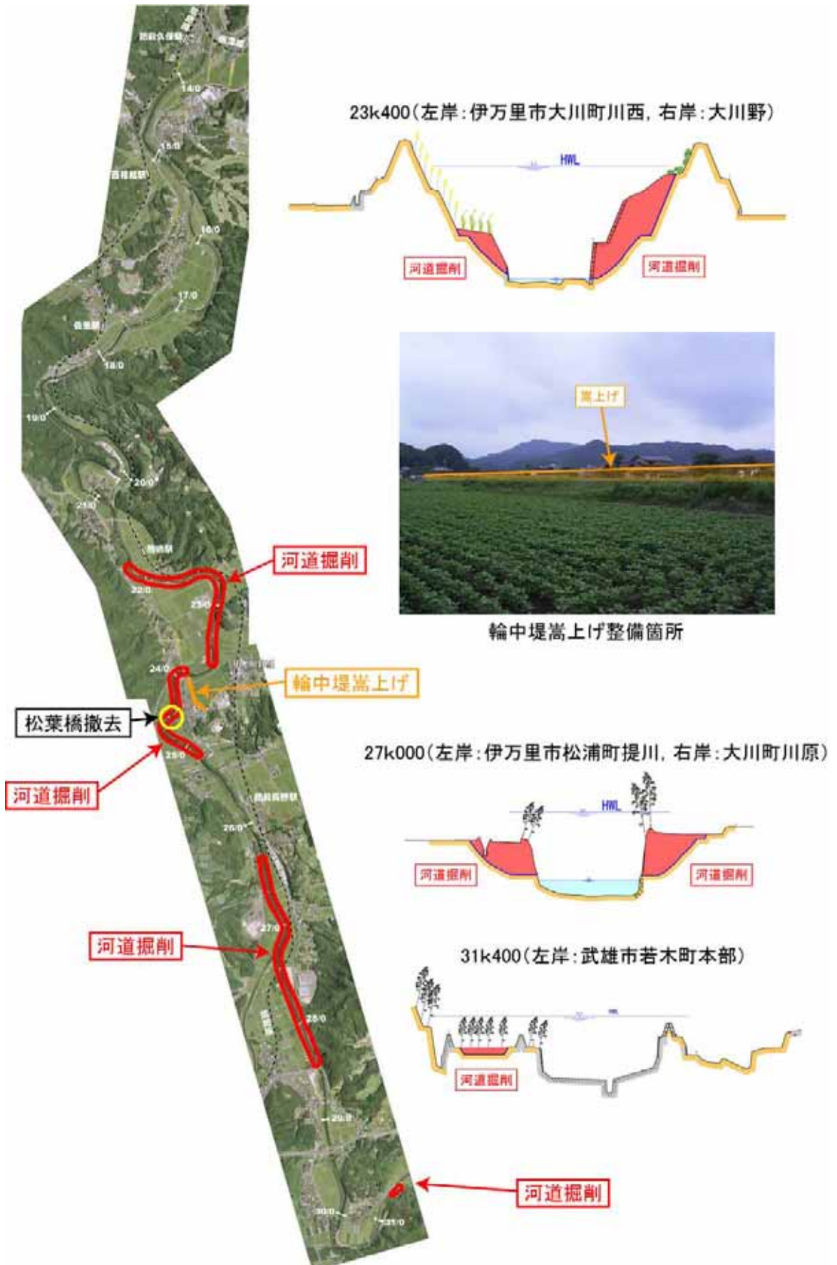
図 4. 2. 6 整備箇所位置図 (松浦川 14k000~直轄上流端)
